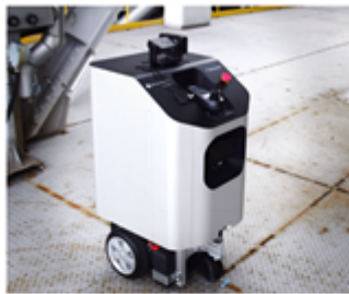
±1cm程の誤差で床面を航行し、正確なポジションから対象を撮影。搭載センサを変えることでさまざまな点検に対応。
